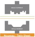
**2 Placer** ces 2 matières en contact avec le moule de formage, soit en appliquant uniquement du vide, soit du vide et une pression.
