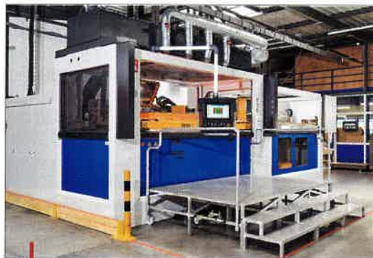
Cette machine Geiss T10 est dédiée aux productions twin-sheets.
