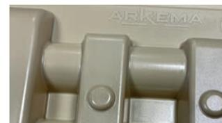
se caractérise par une haute pureté, des COV réduits et une combinaison inédite de propriétés hautes performances (très bonne résistance à l'usure et à l'abrasion, excellente stabilité dimensionnelle, bonne résistance à la fatigue et résistances chimique et diélectrique exceptionnelles). Grâce à l'ensemble de ces caractéristiques, le PEKK peut remplacer le métal dans certaines applications de pointe, ou par ailleurs le poids et la résistance à la corrosion sont des facteurs décisifs.
